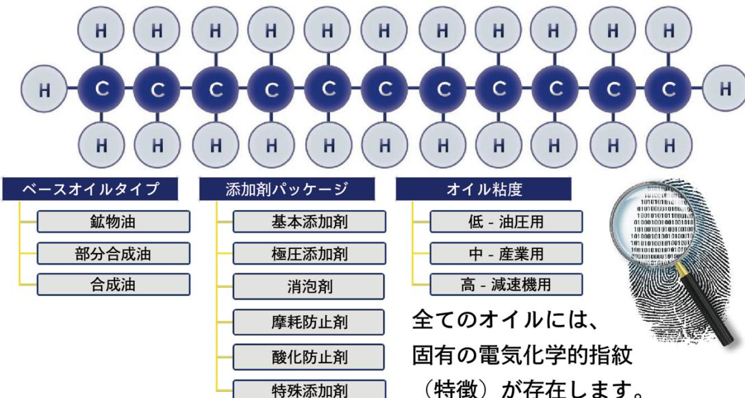
オイルを使用するとエネルギー負荷、化学的変化、化学的負荷などの要因により、オイルの品質が劣化していきます。オイル品質の変化は、オイルの化学組成に不可逆的な影響を与え、その結果、オイルの使用有効性が指数関数的に低下します。
